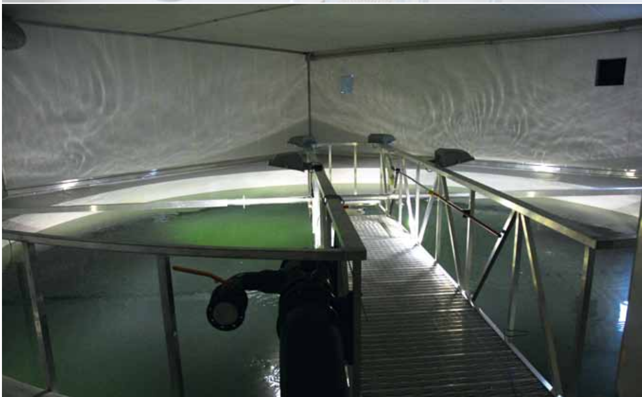
I drift: De ni rommene med hvert sitt 12-meters kar er designet for å drive effektiv lysstyring. De fleste rommene er allerede tatt i bruk.
